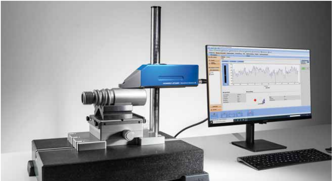
Waveline W40 avec poste de mesure MS300, ordinateur et accessoires en option
