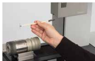
Bras de palpage à fixation magnétique
