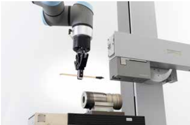
Changement du bras de palpation par le robot – Support magnétique
