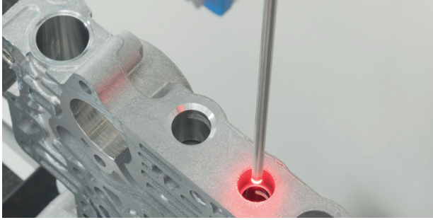
检查孔的内表面
