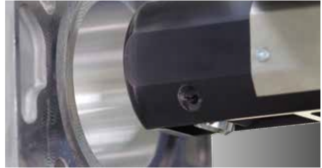
Mesure d'alésage de cylindre avec le système CF1250
