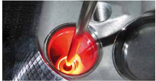
Inspection des alésages d'une culasse
