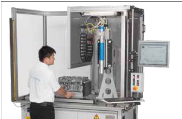
Poste de contrôle à chargement manuel pour prototypes et petites séries
