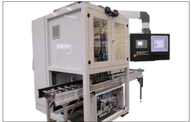
Système avec convoyeur pour la production en série de blocs moteurs
