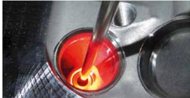
Bohrungsinspektion an einem Zylinderkopf
