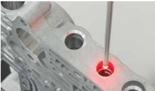
Optische Oberflächeninspektion in Bohrungen (hier: Ventilsteuerplatte)
