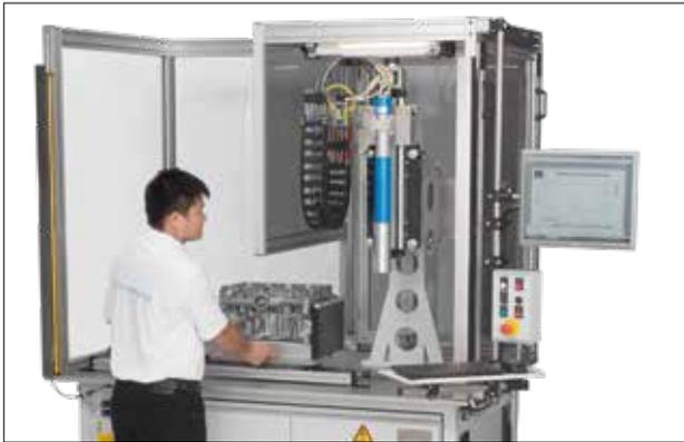
Prüfplatz mit manueller Beladung für Kleinserien-/Prototypenfertigung
