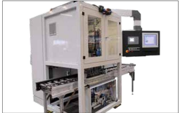
Bandüberbautes System für Reihenmotoren in der Großserienfertigung
