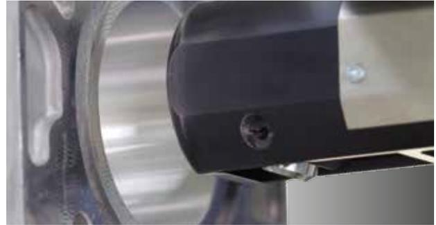
Zylinderbohrungsmessung mit dem CF1250
