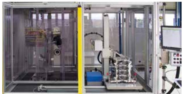
Kombinierte Zylinderprüfung mit CF1250- und B100-Sensoren
