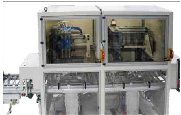
100-Prozent-Prüfung von Zylinderbohrung und Planfläche am Motorblock
