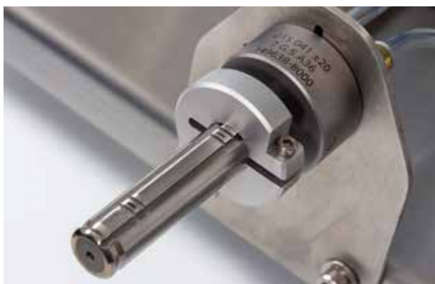
Tampon pneumatique avec deux buses à fente
