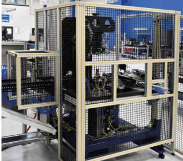
Station de mesure automatique pour les arbres de transmission
