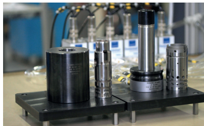
Messring und Messdorn mit mehreren Ebenen zur Paarungsmessung
