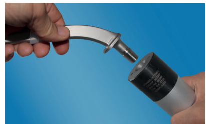
Spezial-Messring zur Messung von Hüftprothesen
