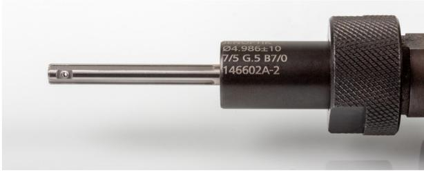
Pneumatischer Messdorn AG100
