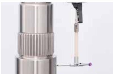
Mesure de la rugosité et de la forme à l'aide d'un système de palpage à double pointe
